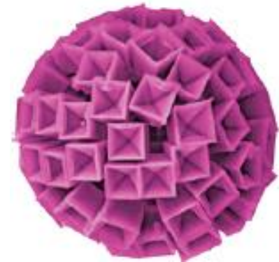
Imagen de SEM de cristales de NaCl crecidos colocando gotas de una solución concentrada de la sal en la interfase ciclohexano-acetona
