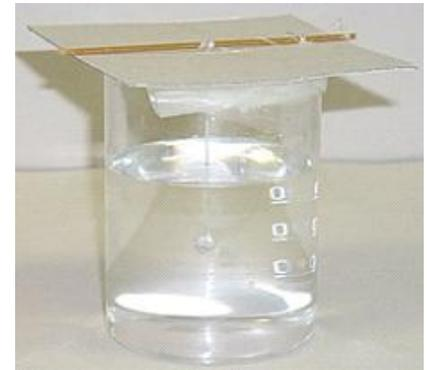
El momento del agregado de la semilla es crítico y puede calcularse a partir del conocimiento de la solubilidad y la metaestabilidad, fijando el punto cerca de la línea de solubilidad y hasta un máximo de  $\frac{1}{4}$  a  $\frac{1}{2}$  dentro de la zona de metaestabilidad o por prueba y error.
