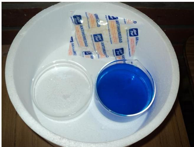
A la izquierda se puede observar la solución de agua y cloruro de sodio; al fondo, la bolsa antihumedad; a la derecha, una solución de agua y sulfato de cobre (perteneciente a otro grupo de trabajo)
