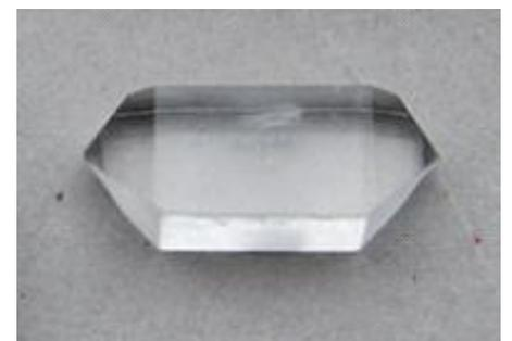
lentamente, por ejemplo dentro de un recipiente de poliestireno expandido se puede lograr un exitoso crecimiento de cristales de KDP. Controlando la velocidad de enfriamiento se da tiempo a las partículas a ordenarse y obtener los cristales más grandes posibles: la velocidad de cristalización es un factor clave para obtener los cristales de gran tamaño.
