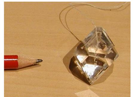
Para obtener cristales de alumbre basta con introducir cuatro cucharaditas de alumbre en polvo en media taza de agua caliente. Después de un cierto tiempo, todo el alumbre se habrá disuelto, dejando una disolución clara. A medida que se evapora el agua, irán formándose unos bonitos cristales de alumbre.
