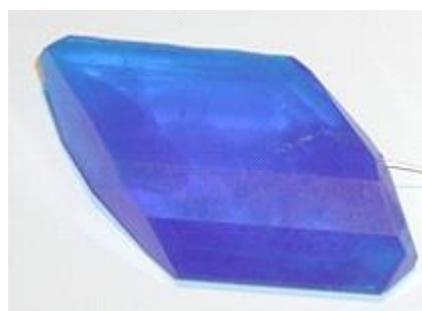
Se obtienen como resultado cristales de sulfato de cobre azul brillante de diversos tamaños y formas, pudiendo hacerse cristales de gran tamaño teniendo suficiente tiempo. Tienen formas hexagonales con lados lisos. Hay variables como temperatura, velocidad de enfriamiento, presencia de impurezas solubles e insolubles y tiempo entre otras, que permiten obtener formas y tamaños bien distintos.
